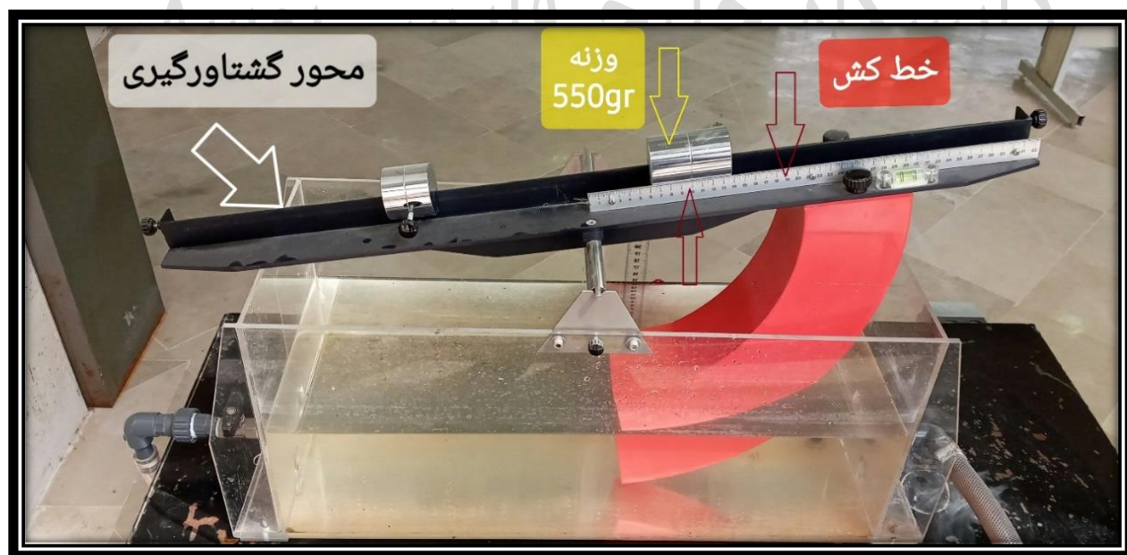
شکل (۱): دستگاه آزمایش مرکز فشار هیدرواستاتیکی
