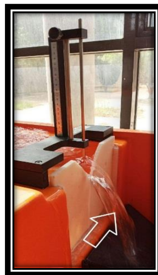
شکل (۴) : سقوط آزاد جریان روی سرریز مثلی
