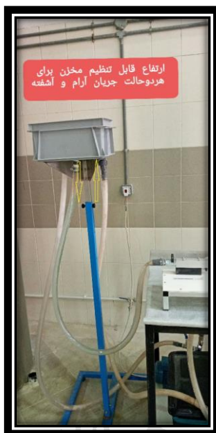
شکل (۵): مخزن آب تغذیه سیستم
