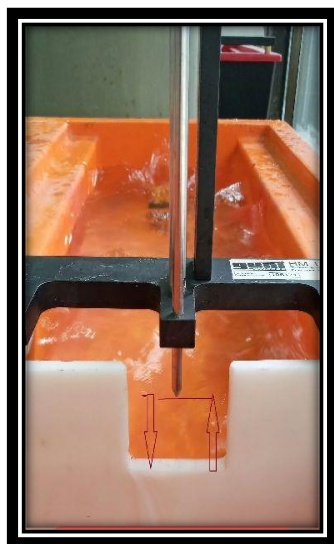
شکل (۵) : محل قرارگیری قلاب میکرومتر
