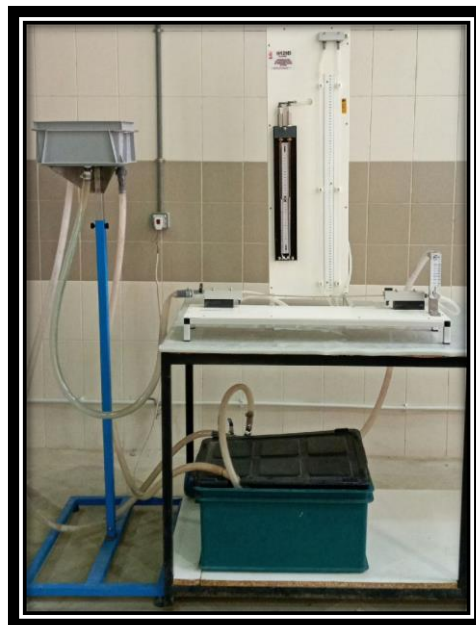
شکل (۱) : دستگاه افت انرژی در لوله مستقیم
