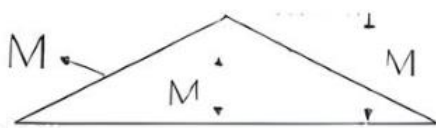
شکل 3) محور ناحیه خمیری در وسط تیر اگر بار وارده به M_p زیاد شود، لنگر خمشی حداکثر به سمت لنگر خمیری میل کند.
