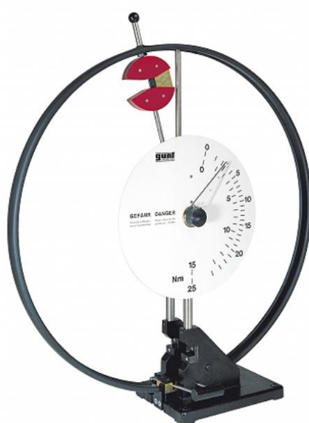
شکل 7) دستگاه تست ضربه
